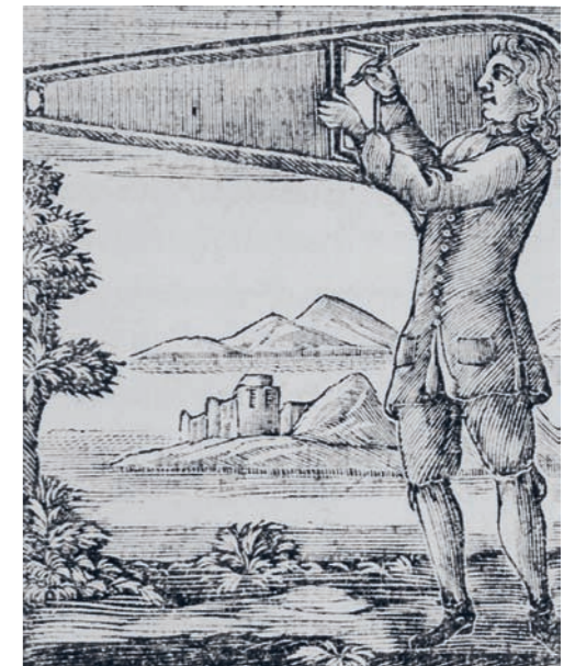
Tragbare Camera Obscura als Zeichengerät Portable Camera Obscura as a drawing device ..... Richard Hooke, 1664 .....
