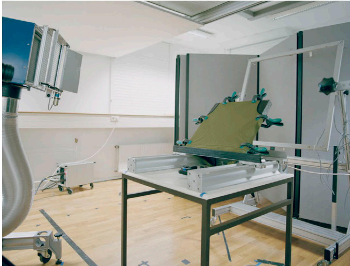
Imaging Technologies Fraunhofer-Institut für Optronik, Systemtechnik und Bildauswertung. Um Aussagen über die spezifische Signatur eines Materials im Wärmebild treffen zu können, wird im Umweltsimulationslabor der Einfluss verschiedener Wetterverhältnisse auf die Darstellung im thermischen Bild getestet. Hier wird eine Weste unter kaltem Himmel geprüft. / Fraunhofer Institute for Optronics, System Technologies, Image Exploitation. In order to give predications about the specific symbol of a material in an infrared image, the influence of different weather conditions on its thermographic appearance are tested in the environmental simulations laboratory. Here a Vest is being tested under a cold sky. Foto / Photo: Lisa Bergmann
